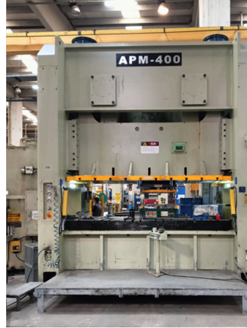
EXZENTERPRESSE-AOMATE APM-400 TONNE (2900 X 1300 3200 X 1500)
