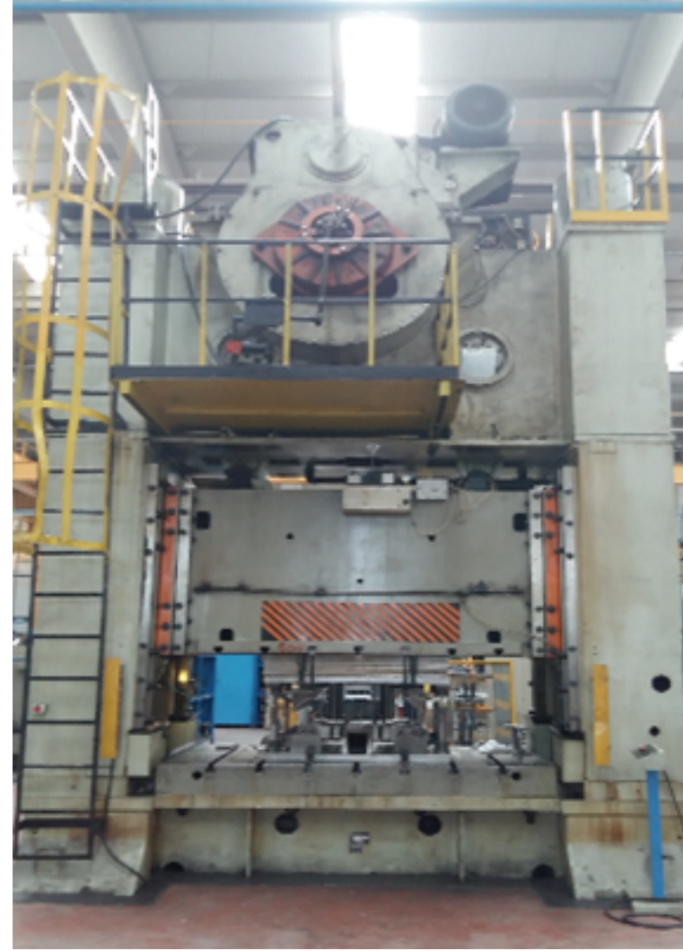
EXZENTRISCHE PRESSE-MILCO 500 TONNE (1250 X 2100 1400 X 2470)
