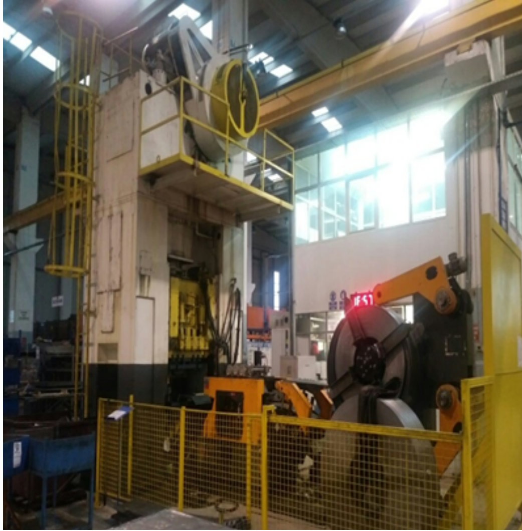
EXZENTRISCHE PRESSE RAVNE 630 TONNE (1240 X 1100 1500 X 1100)
