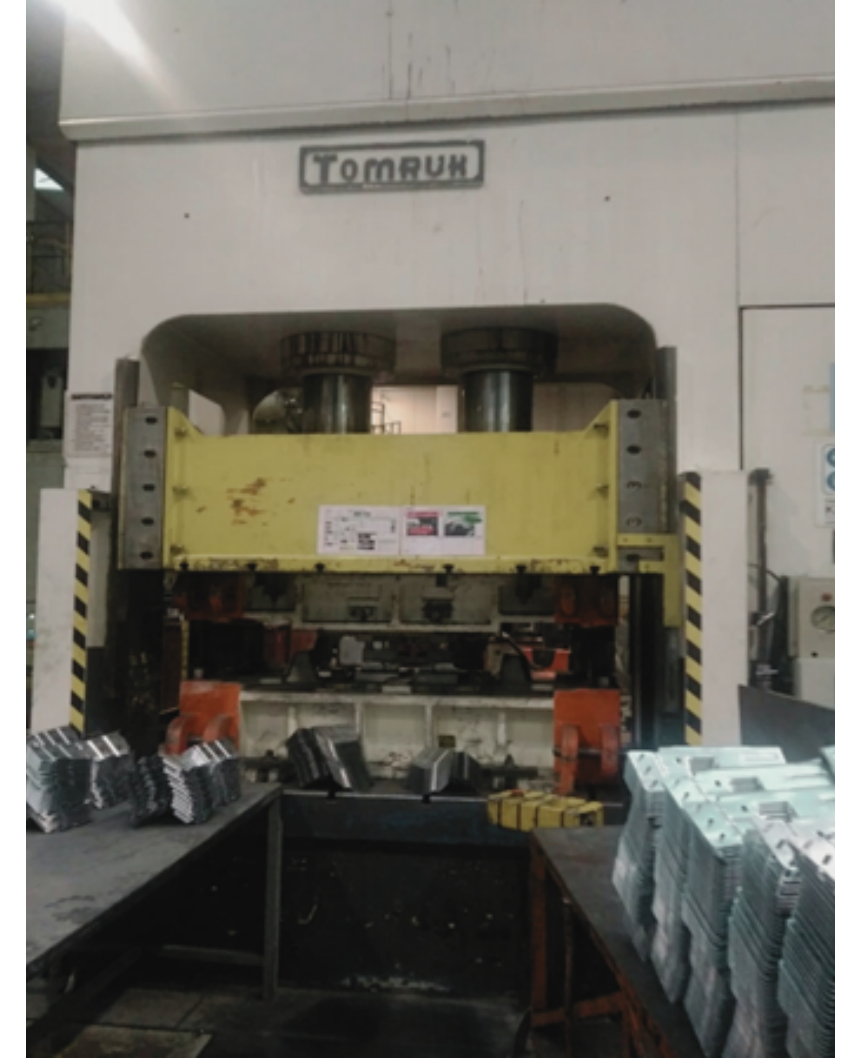
HYDRAULISCHE PRESSE-TOMRUK 350 TONNE (1700 X 1570 1700 X 1520)
