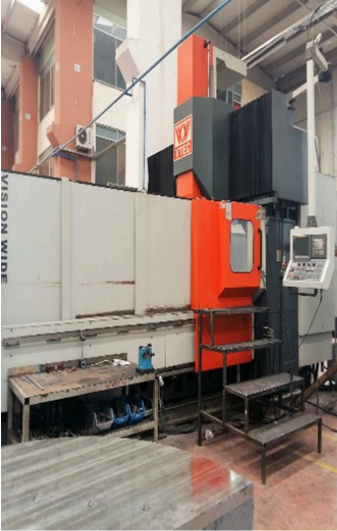
VTEC 3-Achsen-Brücken- CNC-Maschine (x:2450/y:3450/z:900)
