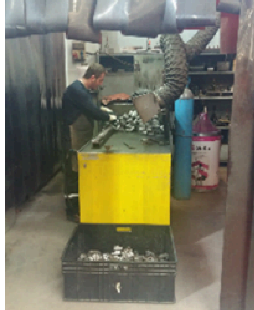
GASUNTERSTÜTZTE QUELLE -Werkbank 1,2 mm Draht / 320-500 A ARCTECH (3 Stück) GEDİK FRONIUS (1 Stück) EXPRESS WELD (1 Stück) TURALLAR (2 Stück) DAIHEN (1 Stück)
