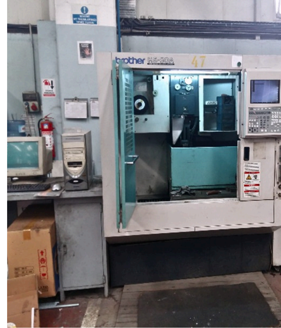
BROTHER HS-50A 4-Achsen- Drahterodiermaschine (x:420/y:260/z:160)
