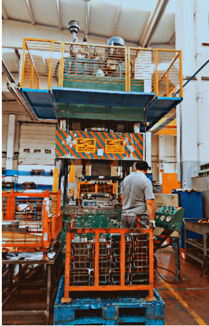
HYDRAULISCHE PRESSE CEMTAŞ 400 TONNE (1200 X 1600 1200 X 1600)
