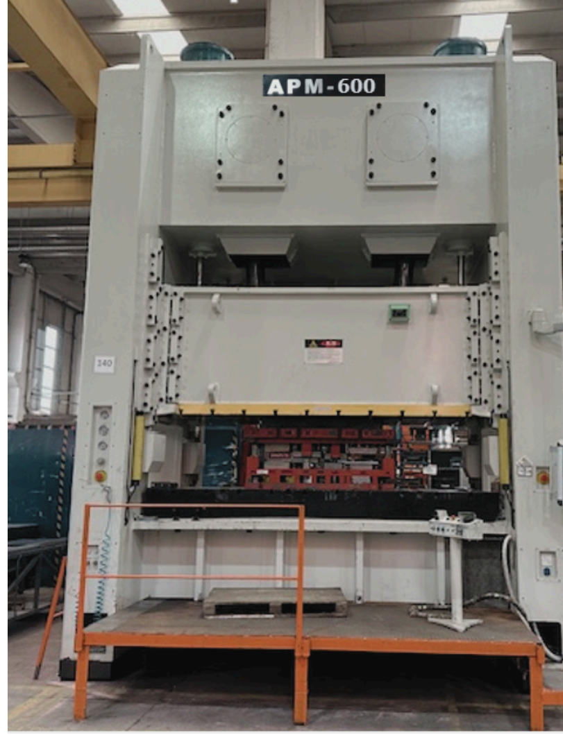
EXZENTERPRESSE-AOMATE APM-600 TONNE (2300 x 1000)
