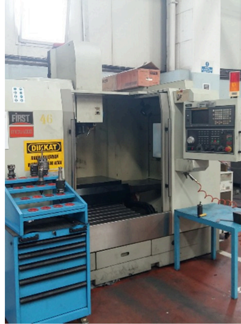
FIRST MCV 1000 3 Achsen CNC Maschine(x:1000/y:500/z:500)
