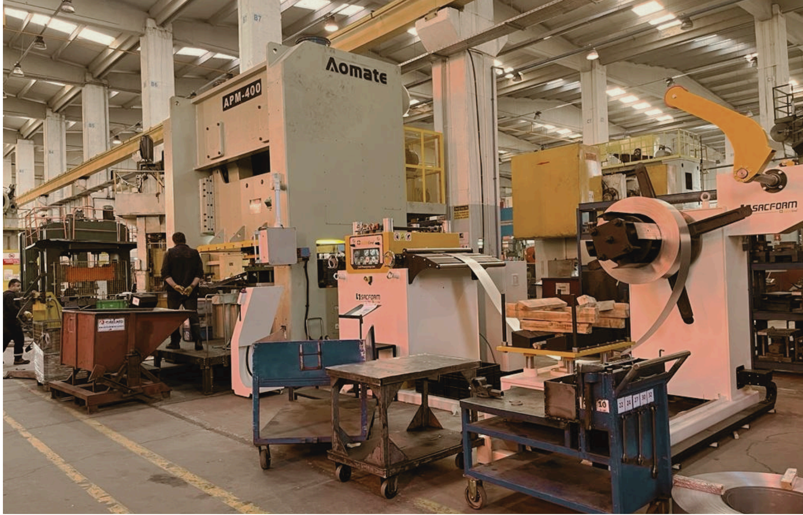
PRÄZISIONSPRESSE APM-400 TONNE (1200 X 1600 1200 X 1600) und ROLLSCHERENANTRIEB
