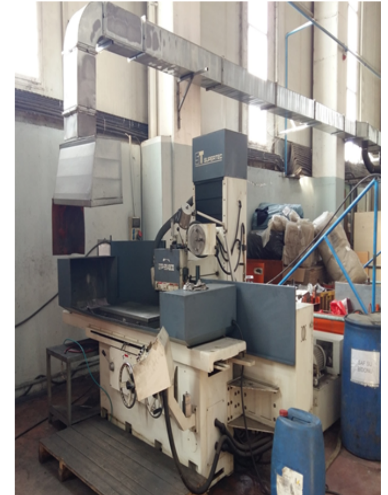
SUPERTEC Line Grinder (x:1000/y:500/z:500)
