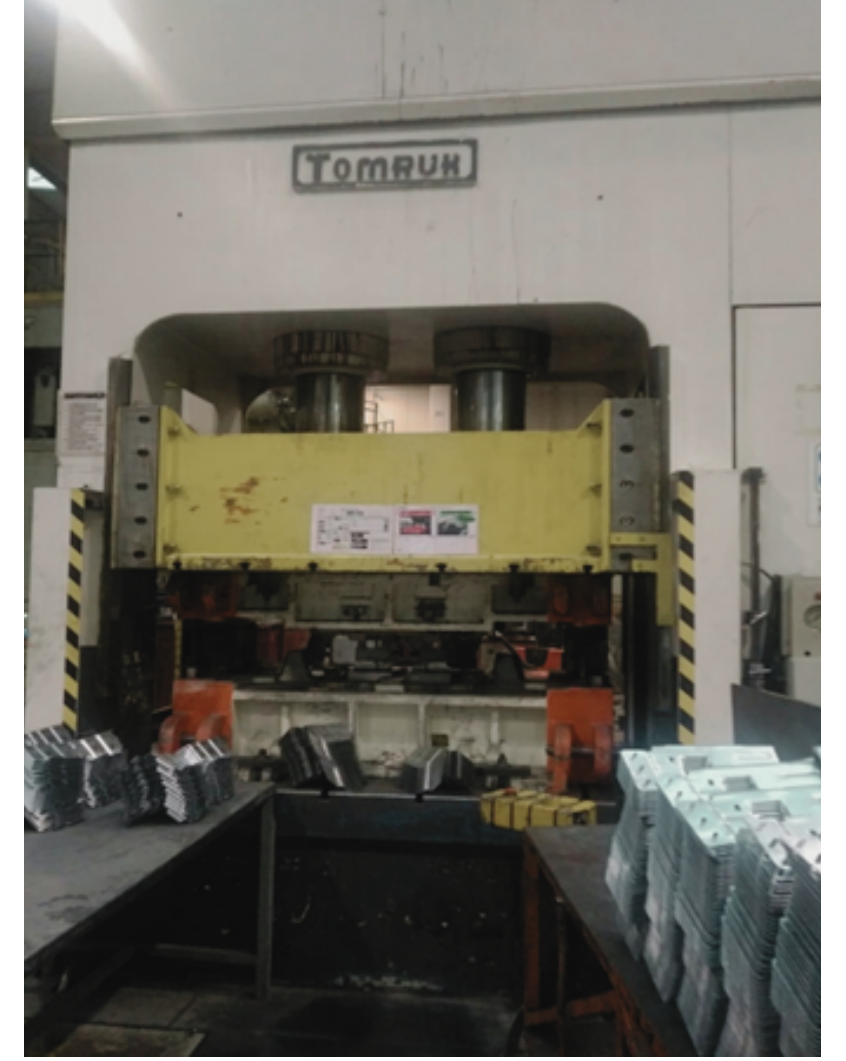
HİDROLİK PRES-LOGGING 350 TON (1700 X 1570 1700 X 1520)
