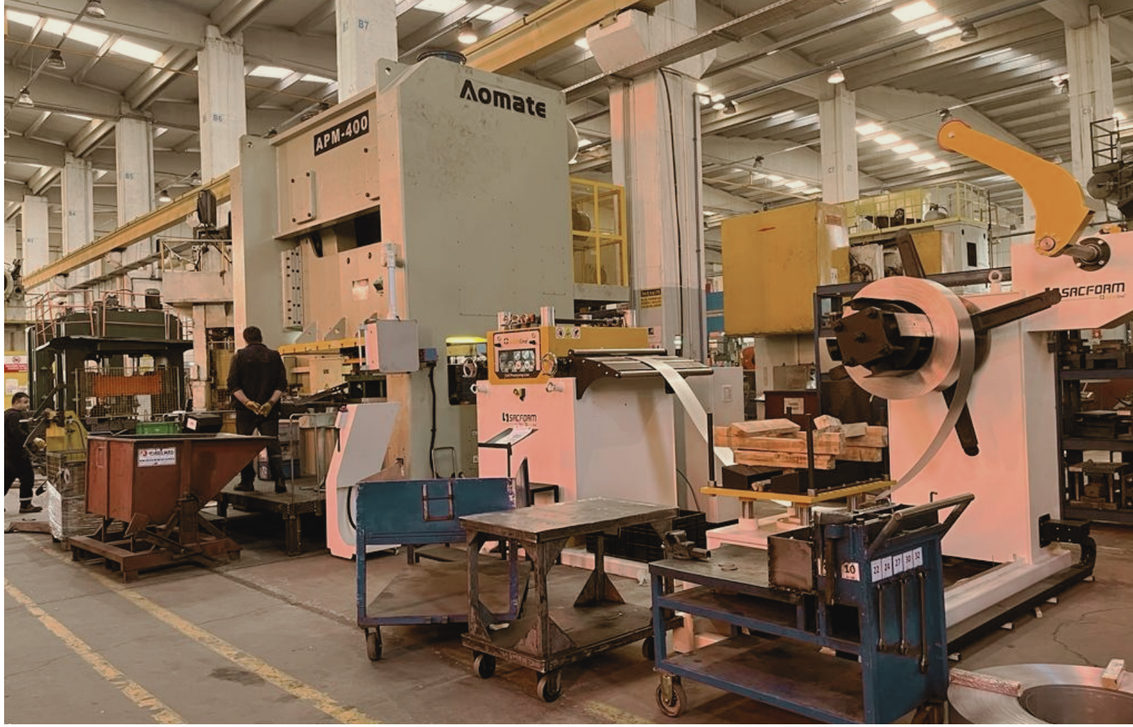
HASSAS PRES APM-400 TON (1200 X 1600 1200 X 1600) ve RULO SAC SÜRÜCÜ
