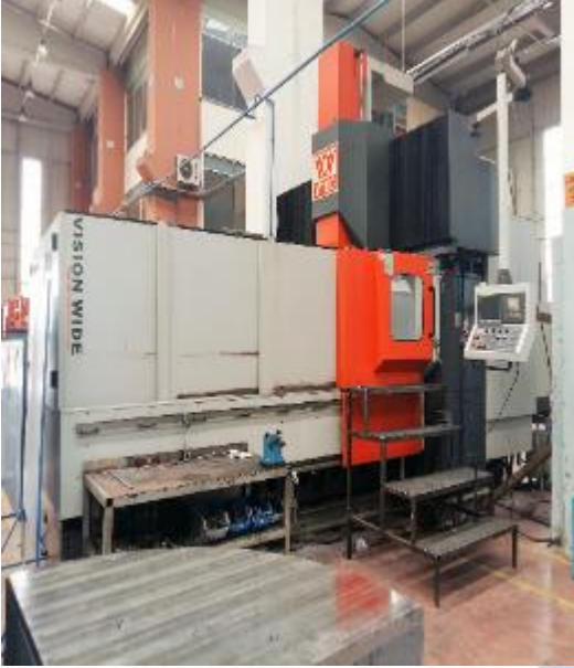
VTEC 3 Eksen Köprü Tipi CNC Tezgahı (x:2450/y:3450/z:900)
