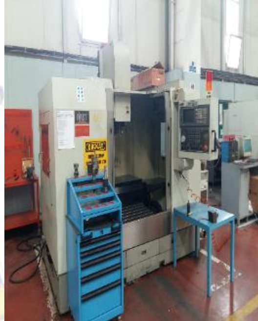
FIRST MCV 1000 3 Eksen CNC Tezgahı (x:1000/y:500/z:500)
